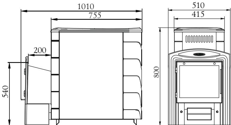
Рисунок 3. Габаритные размеры печи «Тунгуска XXL 2013 Витра»
