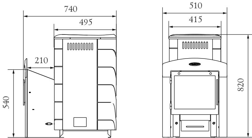
Рисунок 6. Габаритно-монтажные размеры печи «Тунгуска 2017 Carbon Витра»
