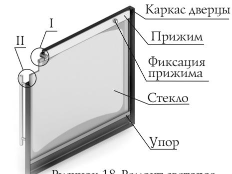
Рисунок 18. Ремонт светопрозрачного экрана дверцы модели «Витра»
