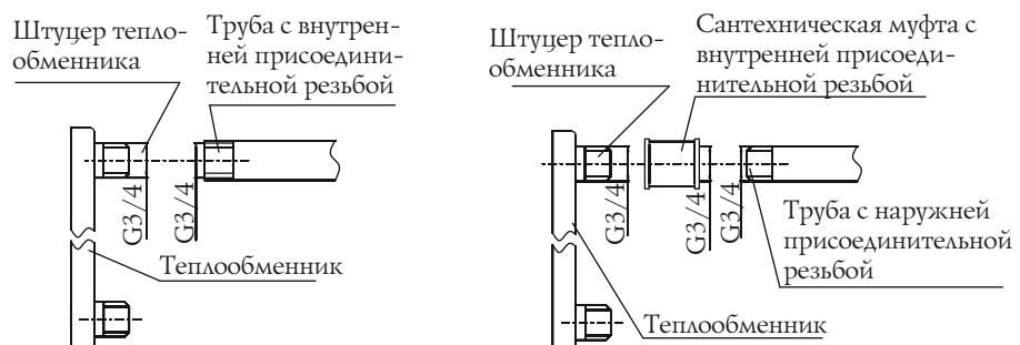
Рисунок 16. Присоединение трубопровода напрямую.
