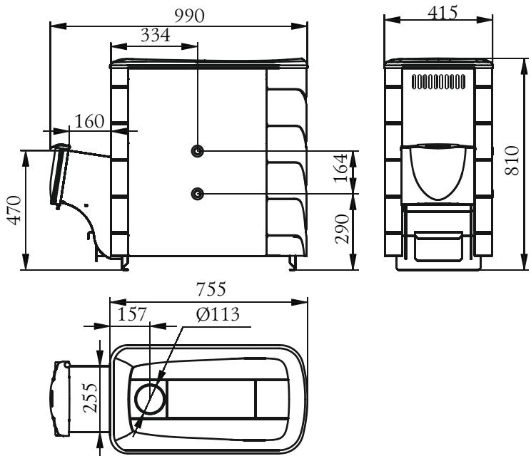
Рисунок 4. Габаритные размеры печи «Тунгуска XXL 2013».
