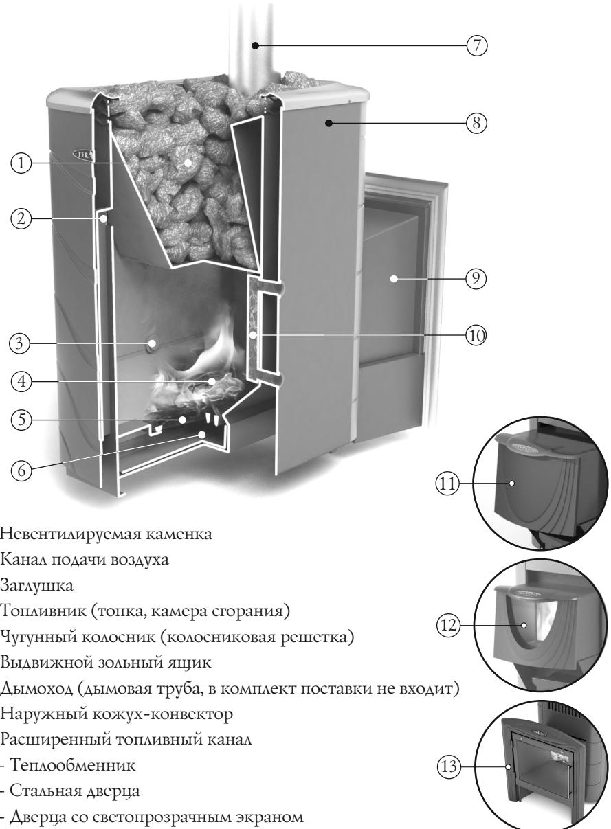
Рисунок 7. Расположение основных элементов печи «Тунгуска» модификация с теплообменником
