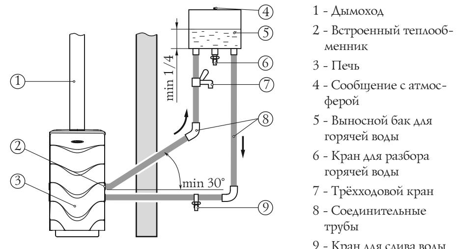
Рисунок 14 Схема монтажа системы водонагрева с использованием встроенного теплообменника
