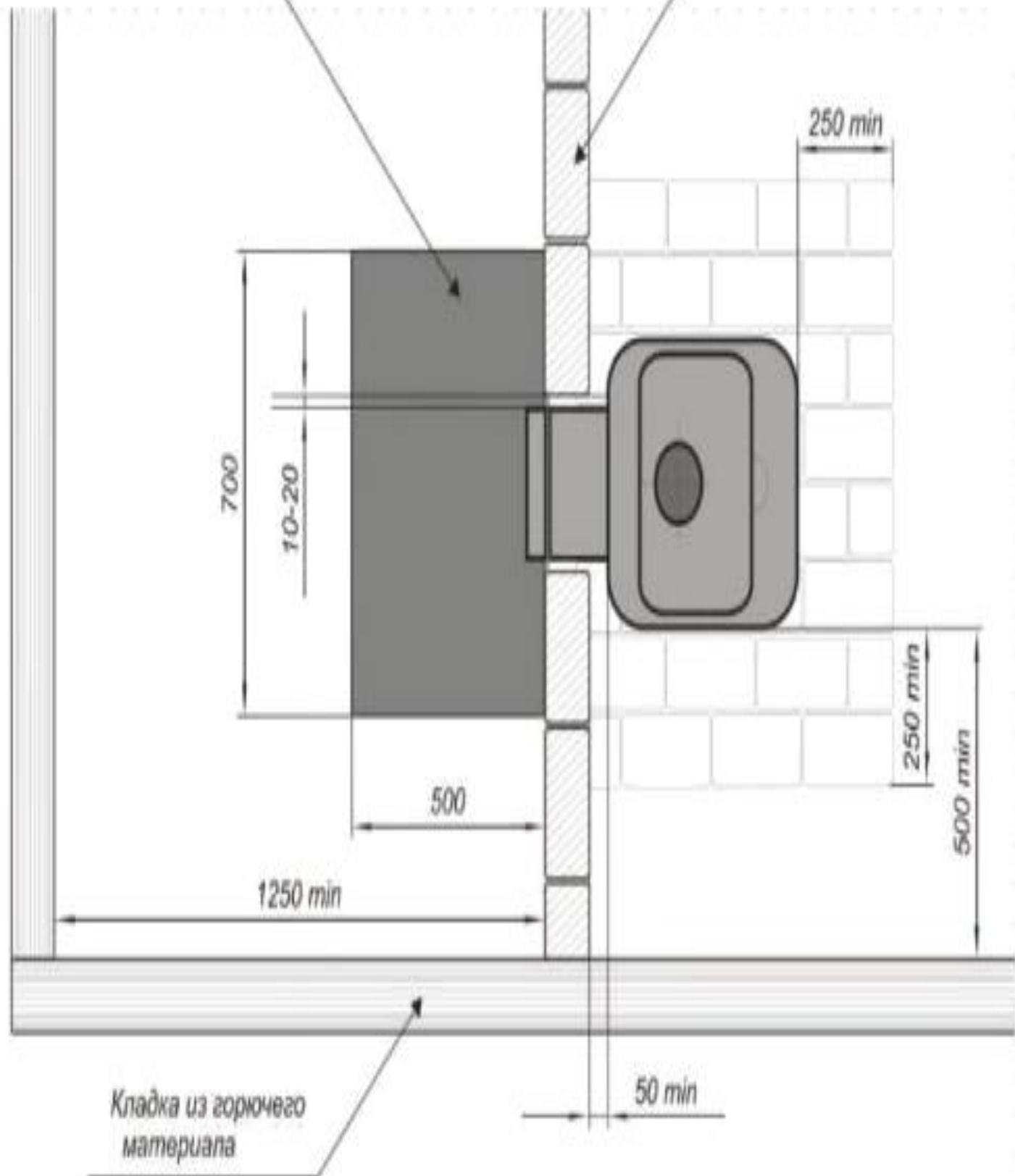
Рисунок 2. Схема установки печи. Вид сверху
