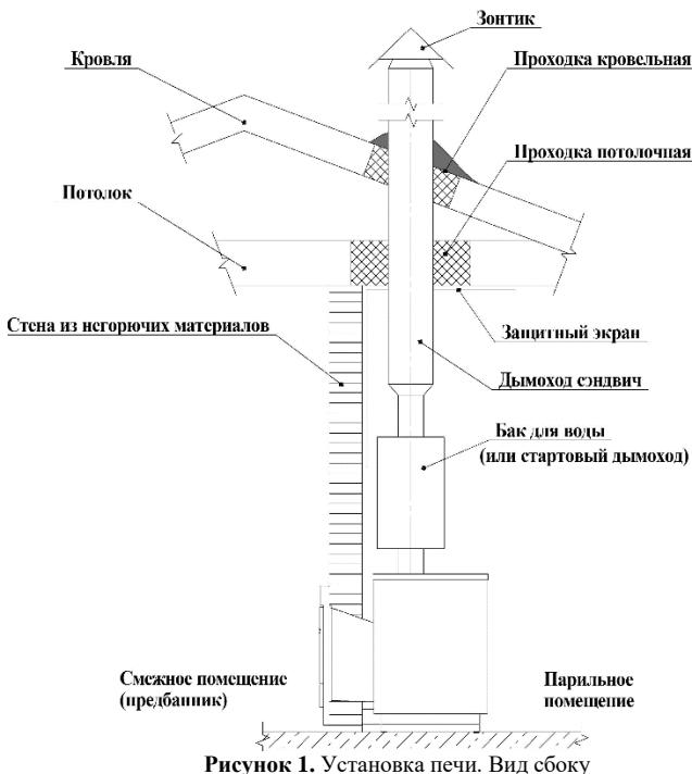
Рисунок 1. Установка печи. Вид сбоку
