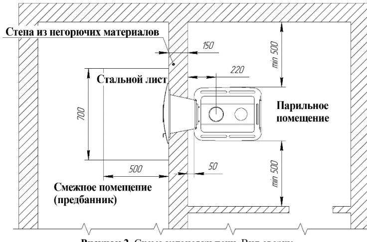
Рисунок 2. Схема установки печи. Вид сверху
