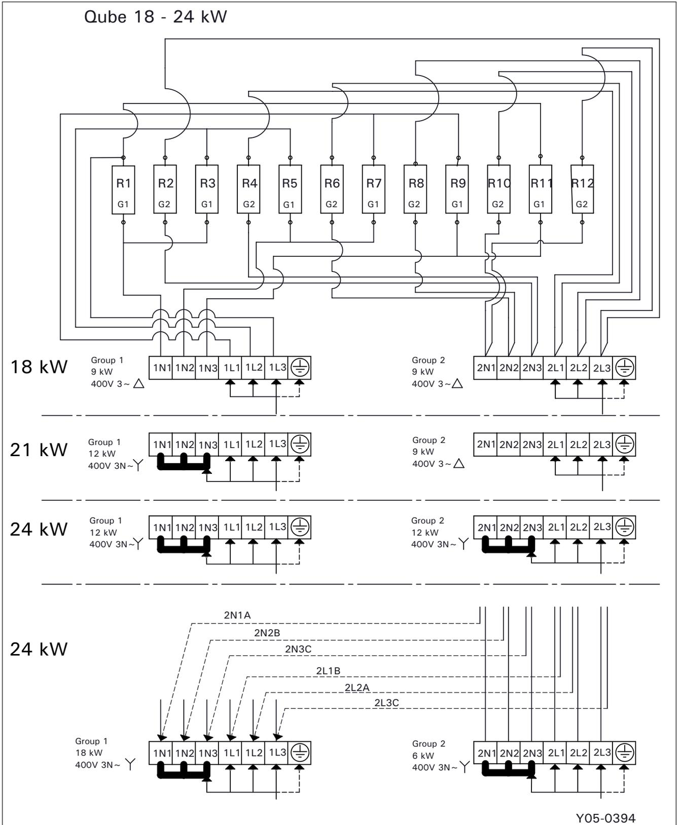
**Рисунок 8. Электромонтаж каменки**
