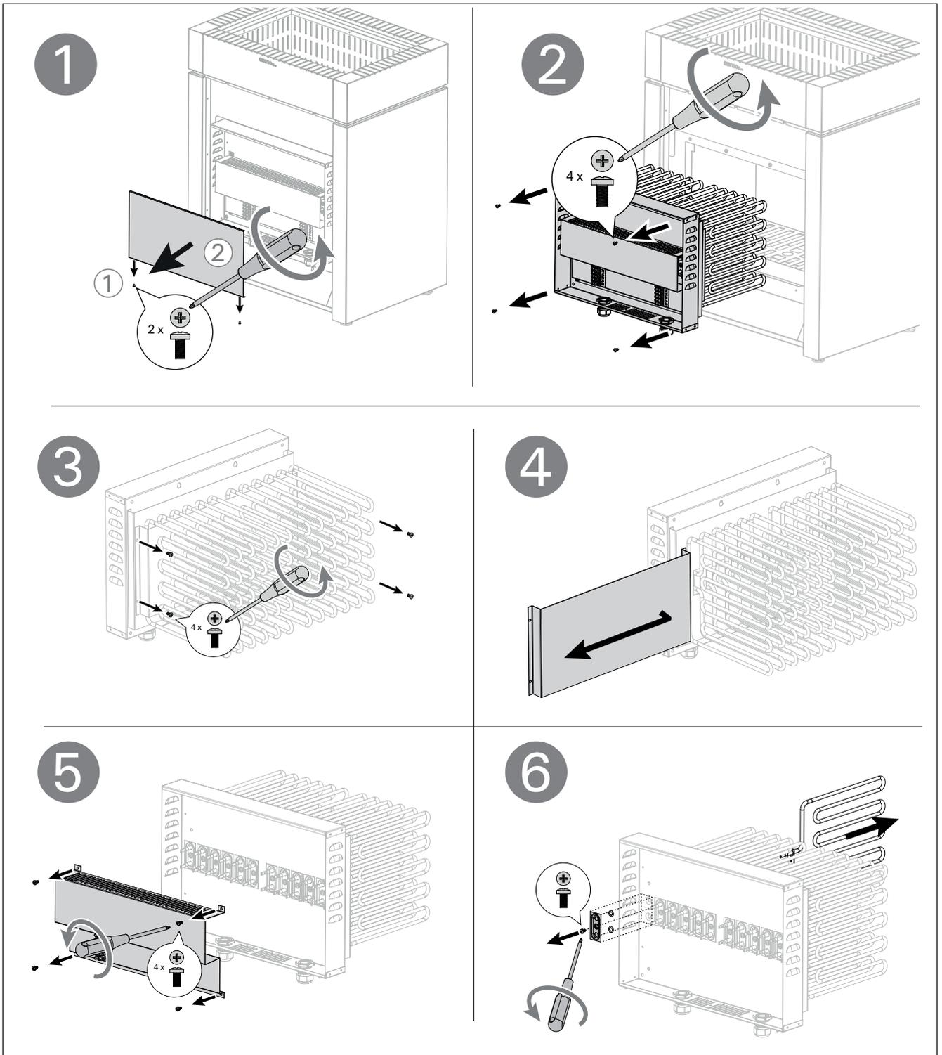
**Рисунок 6. Замена нагревательных элементов**
