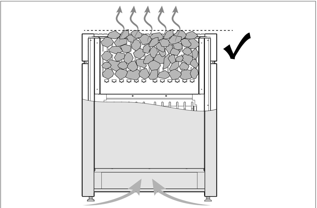
Рисунок 1. Укладка камней
