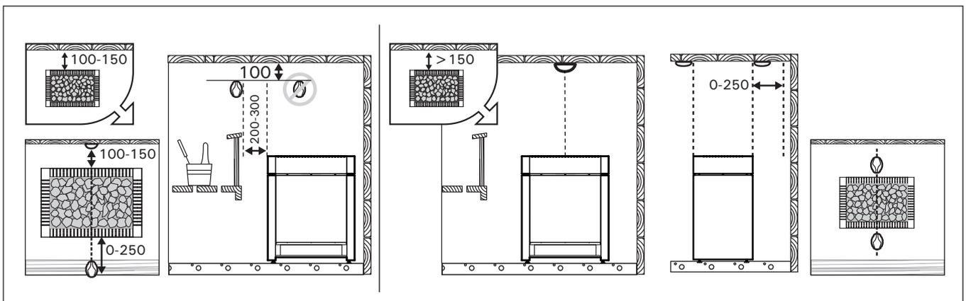
**Kuva 7. Anturin asentaminen (mitat millimetreinä)**
