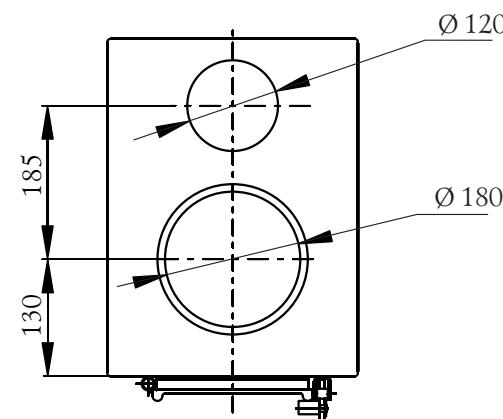
Рисунок 1. Габаритные размеры печи «Золушка 2016».
