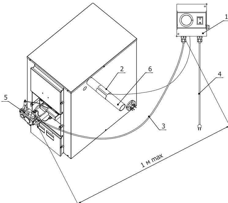
Рис. 9 Схема установки горелки газовой серии АГГ на котлы КУППЕР
