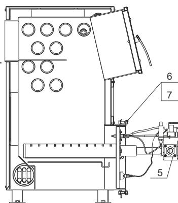
**Рис. 8 Схема установки горелки газовой серии АГГ**
