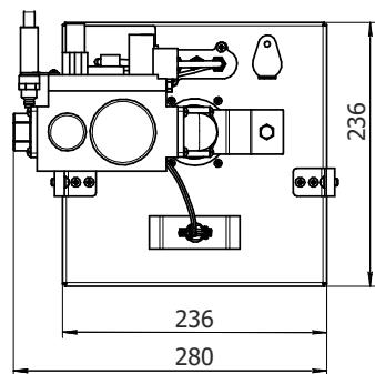
Рис. 5 Габариты горелки АГГ-40К
