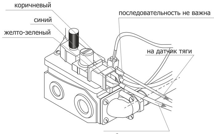
**Рис. 10** Подключение газовой автоматики
