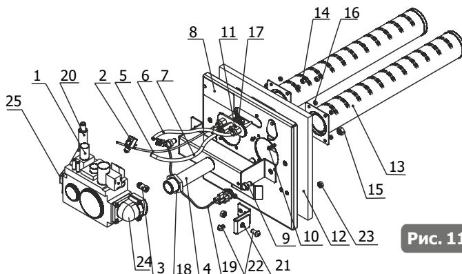
Рис. 11 б Горелка газовая АГГ-26К
