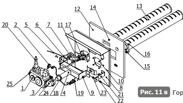
Рис. 11 в Горелка газовая АГГ-40К
