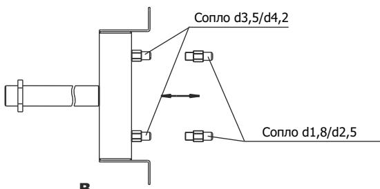
Рис. 12 Переналадка горелки газовой для подключения к сжиженному газу
