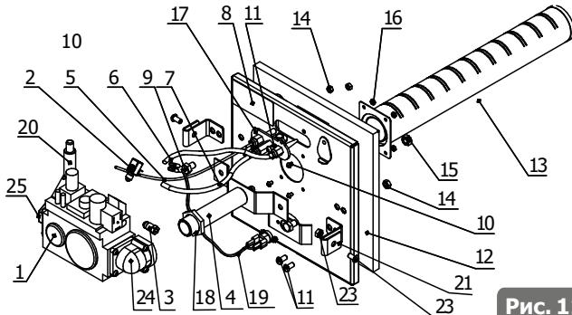
Рис. 11 а Горелка газовая АГГ-13К
