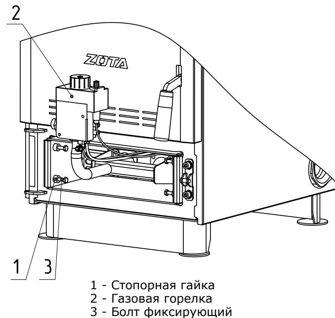
Рис. 2. Установка газовой горелки в зольник
