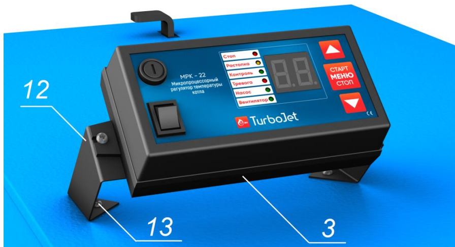
Рис.4. Установка контроллера на корпус котла: 12 – крепежная рамка; 13 – винт из комплекта контроллера; 3 – контроллер.
