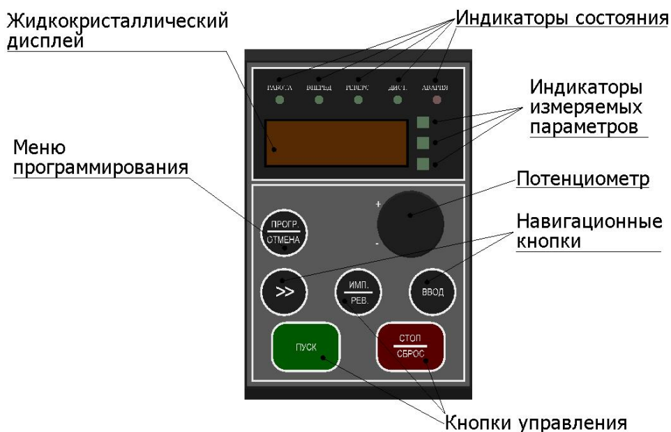
Рис. 6 Функции кнопок преобразования частоты.
