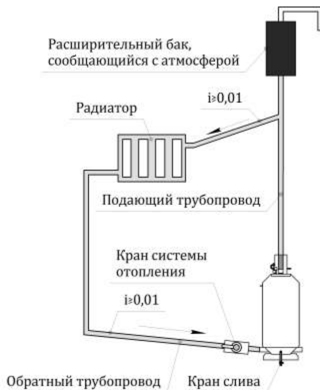
Рисунок 7 – Схема открытой системы отопления с естественной циркуляцией
