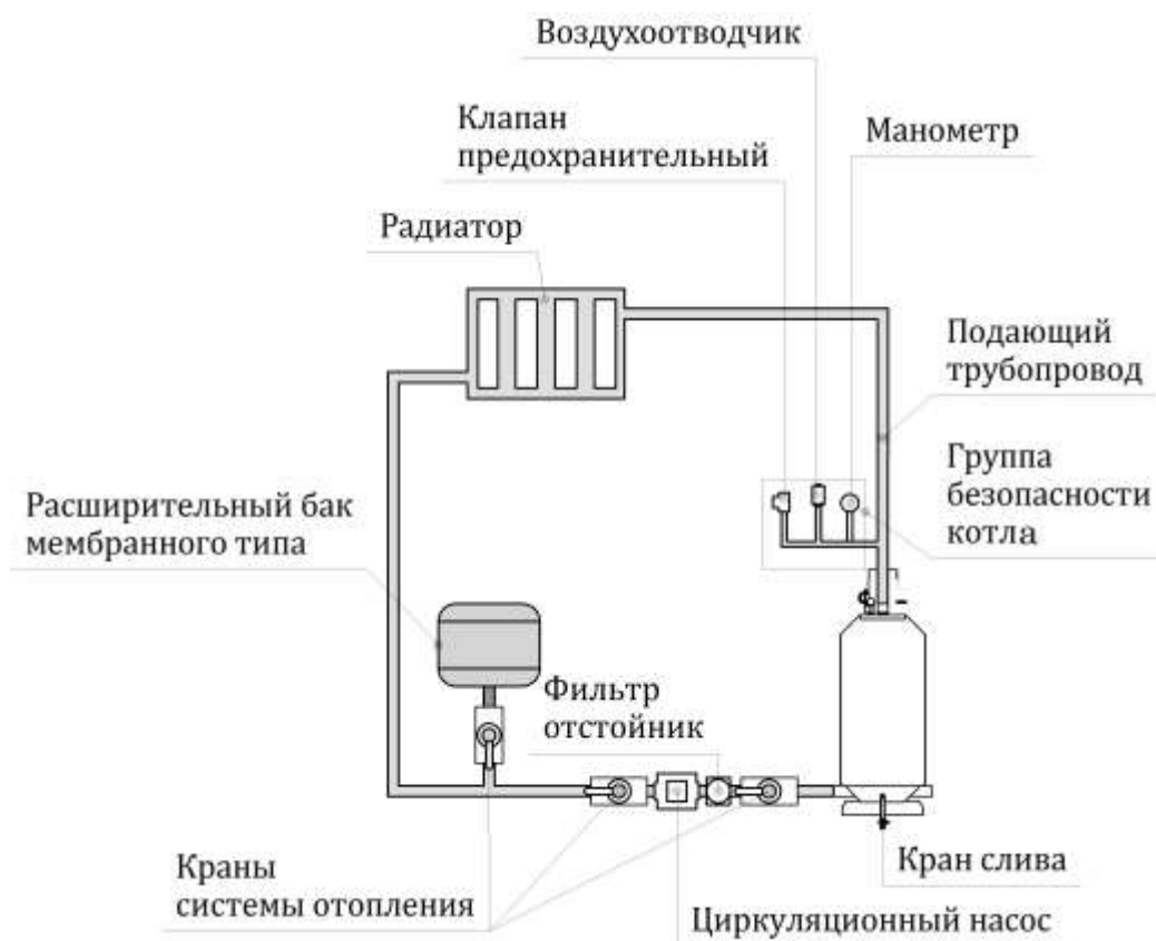
Рисунок 8 – Схема закрытой системы отопления с принудительной циркуляцией
