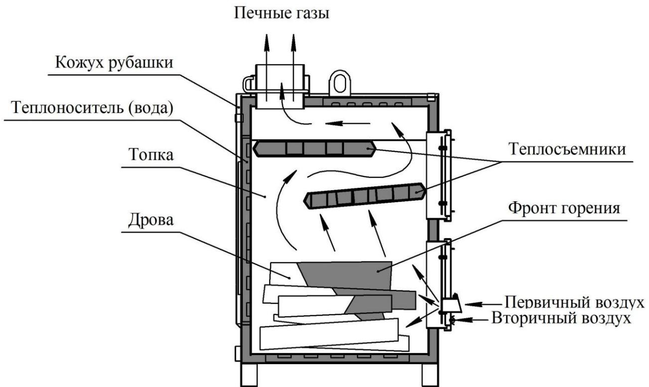
Рисунок 1 – Схема КОД-50
