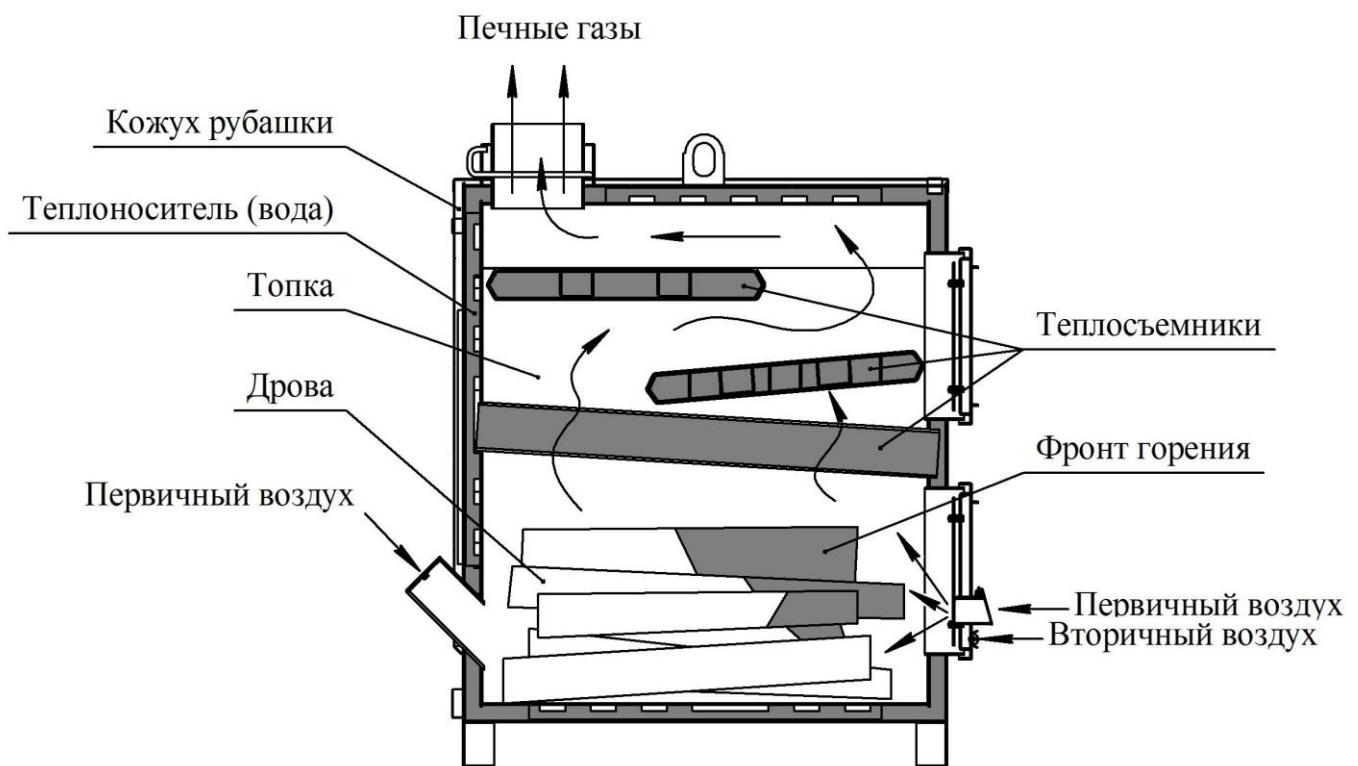
Рисунок 2 – Схема КОД-63, КОД-80, КОД-100
