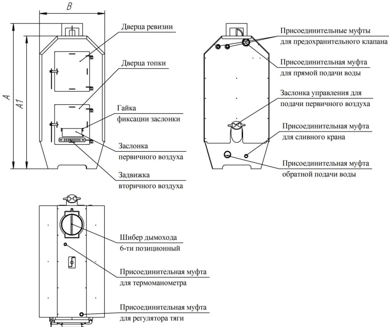
**Рисунок 4 – Общий вид и оснащение котла**
