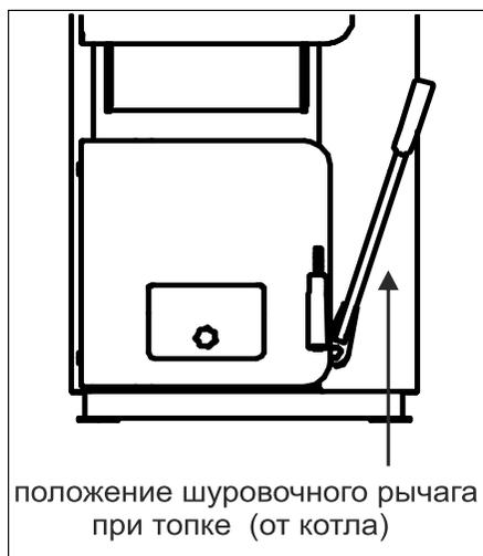
**Рис.10 Установка рычага шуровочного механизма**
