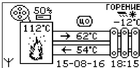
7.3.6. В режиме розжига или режиме автоматического горения можно временно остановить вентилятор для загрузки топлива. Для этого нужно нажать кнопку “Отмена” (3) Рис.2 на пульте управления. Вентилятор остановится и на экране появится сообщение с предложением загрузить топливо.
