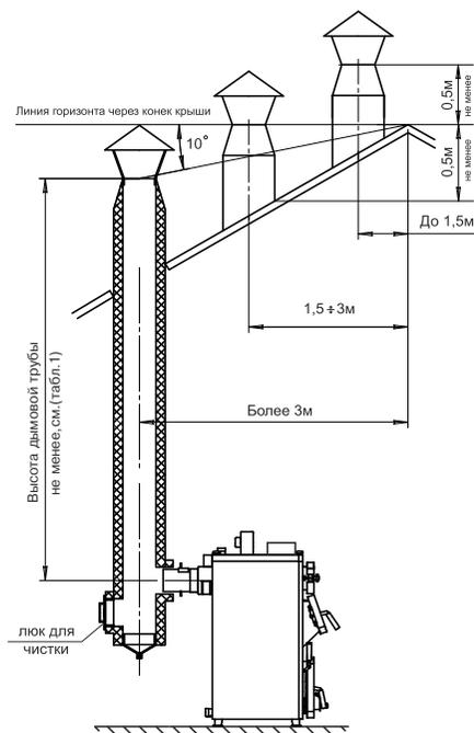
Рис.6 Варианты установки дымовой трубы
