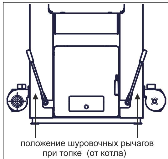
**Рис. 10 Установка рычагов шуровочного механизма**
