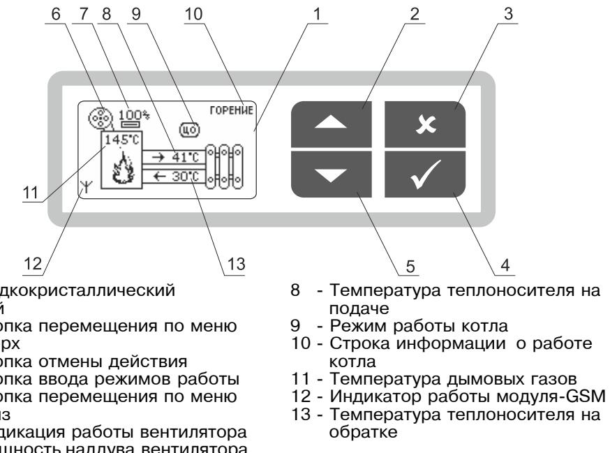
**Рис.2 Расположение органов управления и индикации на передней панели пульта.**
