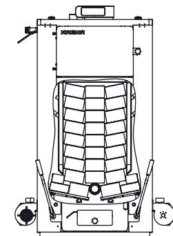
**Рис.9 Варианты укладки топлива**
