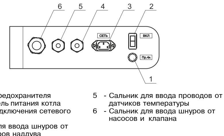
**Рис.3 Расположение органов управления на задней панели пульта.**
