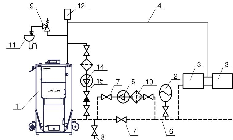
Рис.7 Схема закрытой системы отопления
