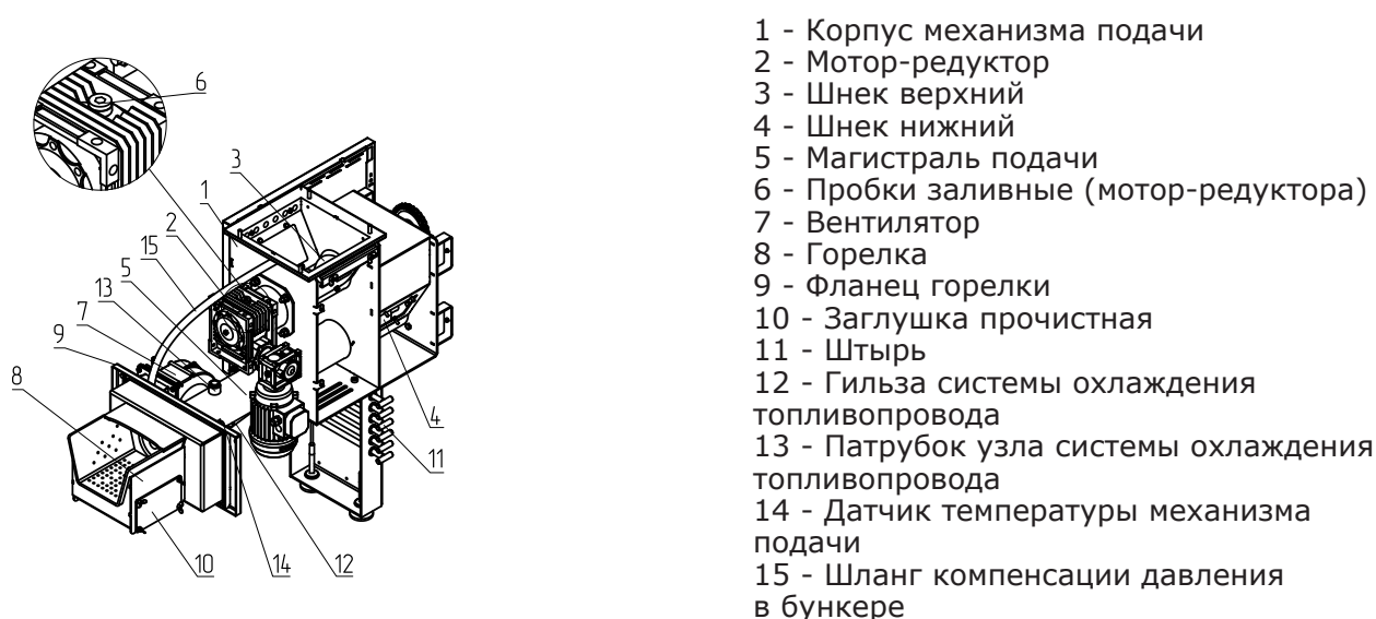
Рис.3 Горелка лотковая Stahanov 16-65.
