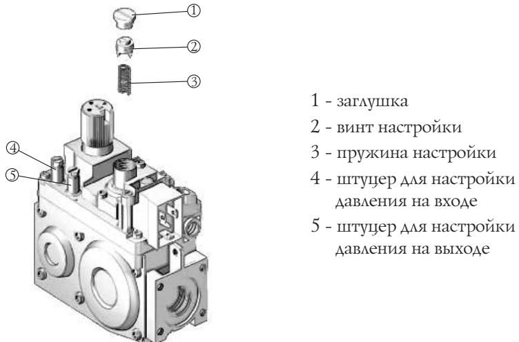
Рисунок 15. Элементы настройки давления подачи газа.
