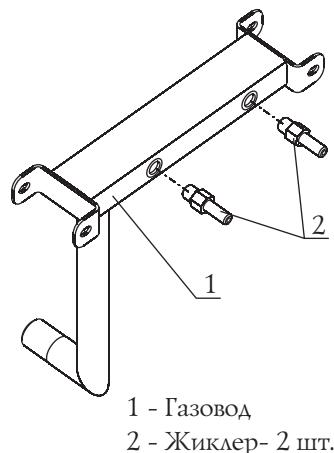
Рисунок 10. Сборка газовода.
