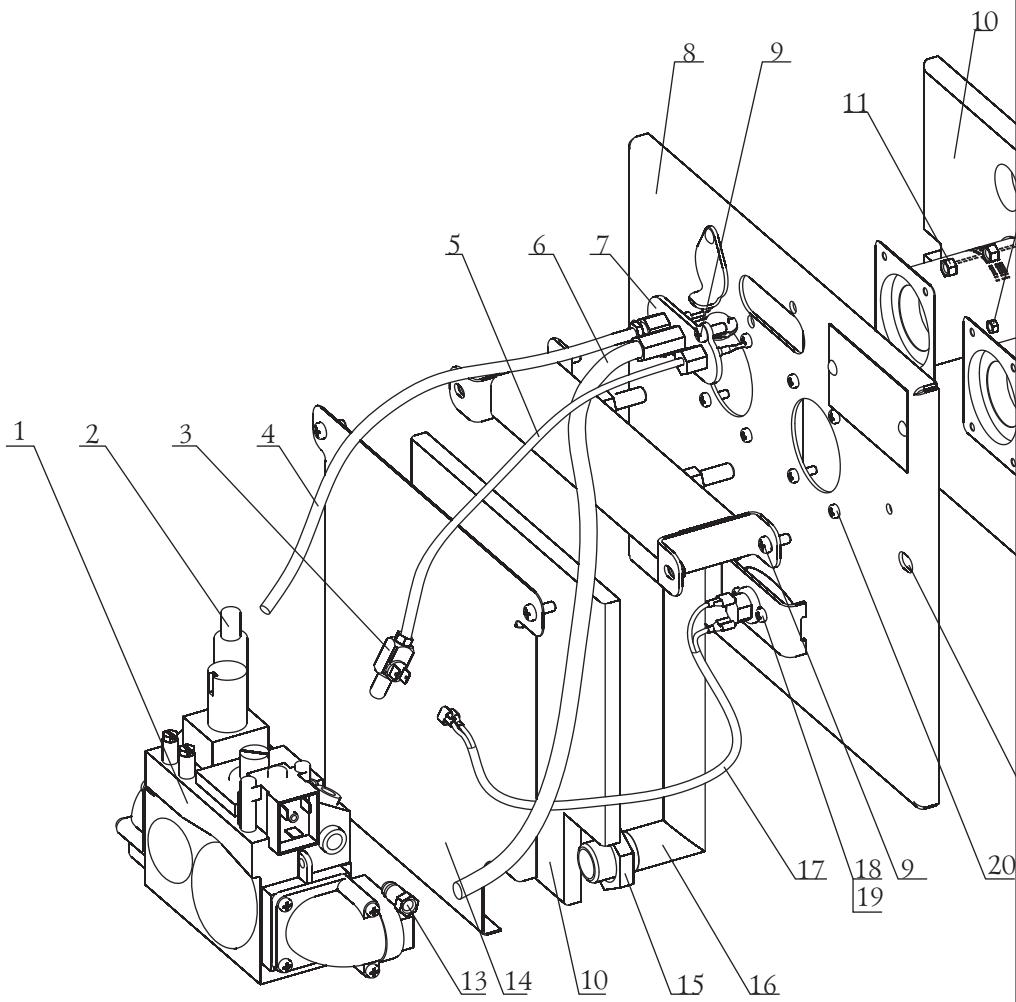
Рисунок 11. Составные части и порядок сборки газогорелочного устройства «Сахалин»
