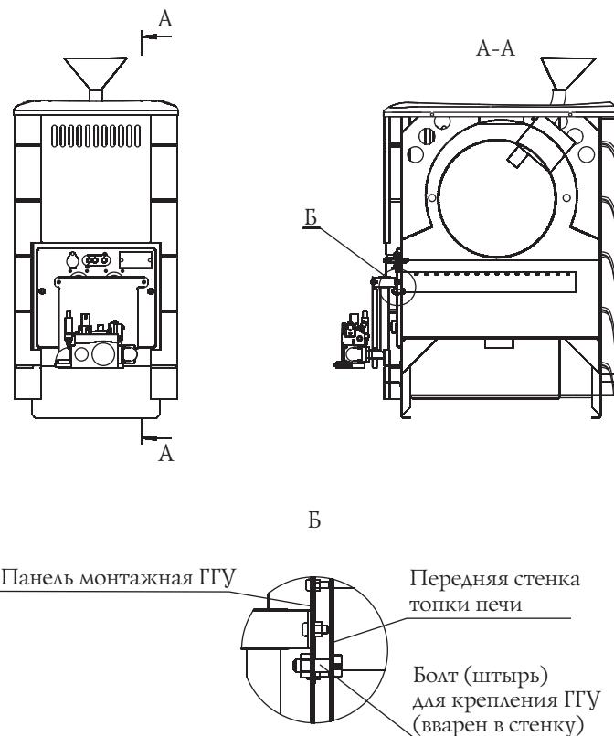
Рисунок 13. Установка ГГУ на печь банную «Таймыр»
