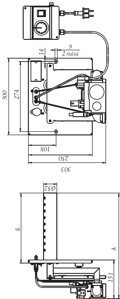
Рисунок 1. Габаритные размеры газогорелочного устройства «Сахалин-1»
