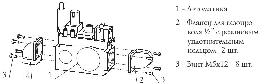
Рисунок 9. Установка фланцев для газопровода на автоматику 820 NOVA.
