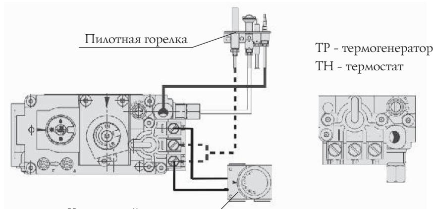
Рисунок 14. Подключение энергонезависимой автоматики.
