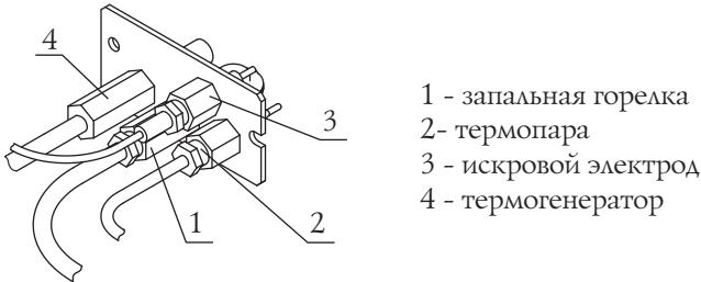
Рисунок 12. Вид полотной горелки в сборе для энергонезависимого ГГУ
