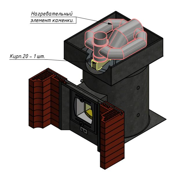
Лишний супервул срезаем ножом и устанавливаем на-гревательный элемент каменки. Под выходной патрубок подкладываем Кирп. 20.
