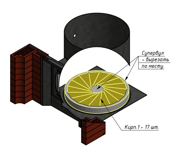
Далее выкладываем по кругу кирпичные детали1, заполняя пустоты супервулом, как показано на рисунке.
