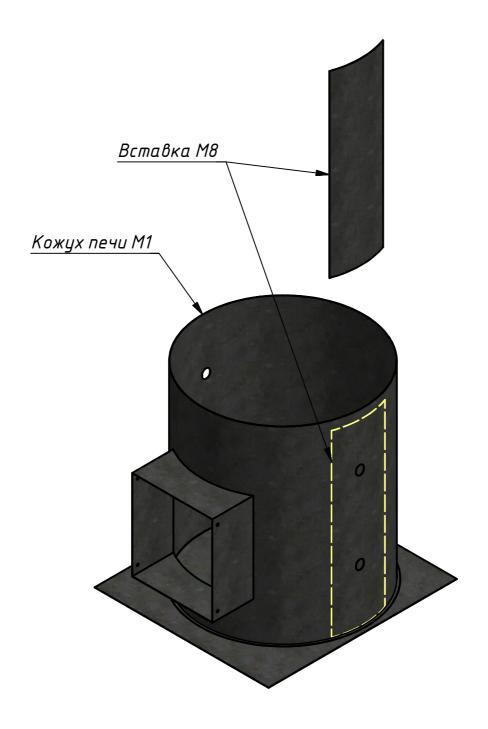
Устанавливаем кожух печи. Лишние отверстия под теплообменник закрываем вставками из металла.
