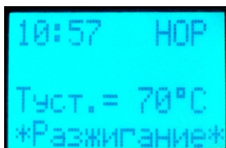
Рисунок 12 – Вид панели управления в режиме РАЗЖИГАНИЕ
