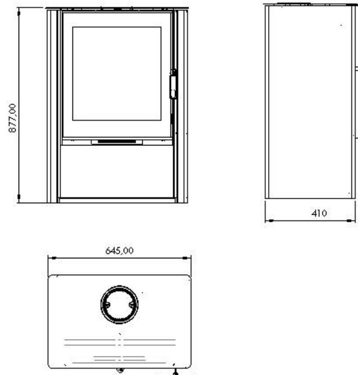
Рис. 1. Схема печи-камина
