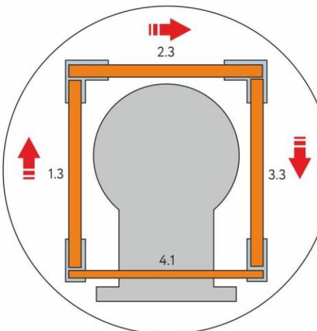
5. Третий ряд отличается от первого и второго только заменой узких элементов на целую плиту под номером 4.1. Устанавливаем скобы сверху.
