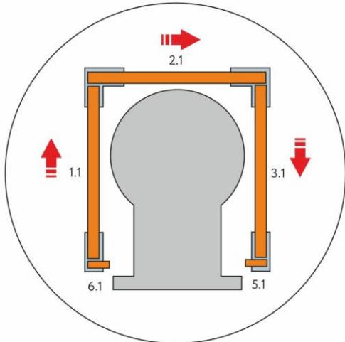
2. Далее собираем печь слева на право, если смотреть со стороны портала. Ставим плиту под номером 1.1 на установленные ножки, потом 2.1 и 3.1, вставляем узкие элементы у портала 5.1 и 6.1.
