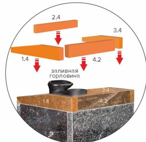
6. Четвертый ряд. Под заливную горловину устанавливаем самую узкую деталь (2.4), на противоположенную сторону самую высокую (4.2), а между ними располагаем элементы (1.4) и (3.4).
