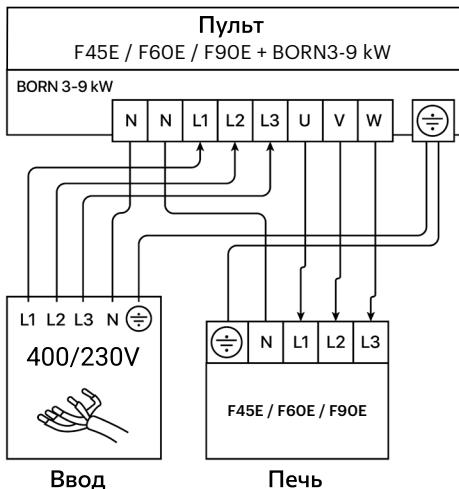
Если соединительный или монтажный кабель подходят к сауне, или сквозь стены сауны, на высоте более 500 мм, они должны выдерживать при полной нагрузке температуру 170 °C. Приборы, устанавливаемые на высоте более 500 мм от уровня пола сауны, должны быть пригодными для использования при температуре 125 °C (маркировка T125).
